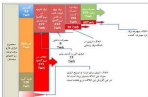
نمودار ۳: تولید برق در سال ۱۳۹۰ در نیروگاههای حرارتی و میزان اتلاف آن از تولید تا مصرف
