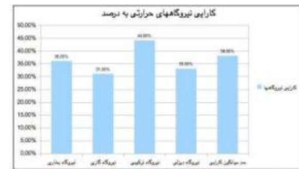
نمودار شماره ۱: حداکثر میانگین کارایی قدرت عملی نیروگاههای حرارتی ایران در سال ۱۳۹۰
