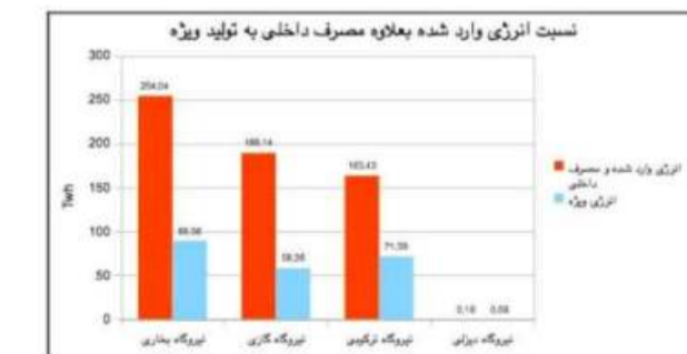
نمودار ۱۲: میزان انرژی وارد شده به نیروگاهها علاوه انرژی مصرف شده در نیروگاهها و تولید برق ویژه نیروگاههای مختلف در سال ۱۳۹۰. در حقیقت میزان اتلاف انرژی ستون قرمز ستونهای ستون آبی می‌باشد.
